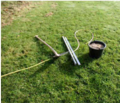
1. Udstyr til infiltrationstest: Haveslange, skovl, grus, retskinne og målestok/målebånd.
