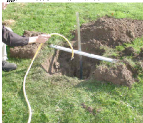
4. Vandmætning af jorden kan begynde. Der fyldes min. 0,20 m vand over gruslaget.
