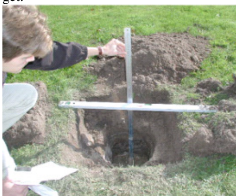
6. Der lægges en retskinne over hullet, og herfra måles nedstik til vandoverfladen.
